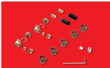
• **Conjunto de ligações hidráulicas entre coletores FKC-2 para instalação em telhado plano**, composto por: 2 cotovelos em latão; 2 porcas de 3/4"; 2 anilhas de aperto de 18 mm; 2 porcas G1; 2 suportes para tubagens de impulsão; 2 tampões em latão; 1 bucin para ligação da sonda de temperatura; 1 chave Allen para a instalação dos coletores sobre as estruturas de suporte • **Necessário um jogo de ligações FS 22-2 por cada grupo de coletores**
