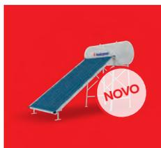
• **Kit termossifão de 200 litros, para instalação em telhado plano** que inclui os seguintes componentes: • Coletor solar para instalação na vertical (FCC-2S) • Depósito de acumulação de cor cinza, de dupla envolvente de 145 l de capacidade útil, com possibilidade de apoio elétrico (TS 200-2E) e vaso de expansão incorporado • Kit de acessórios de ligação, com tubagens em EPDM reforçadas com nylon (HTSS 200) • Estrutura de suporte para telhado plano, fabricada em aço galvanizado (MTSS 1)
