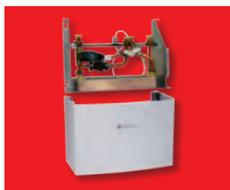
• Utilizado para ligação de sistemas solares com equipamentos de apoio (caldeiras murais) por cada apartamento; Inclui permutador de calor de placas de 28 kW; Inclui válvula misturadora; Temperatura de saída de 45 °C +/- 2 °C • **Dimensões:** A 225 x L 400 x P 210 mm
